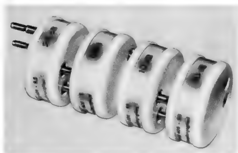
Durch mahlweises Zusammenstecken der vier Dämpfungsglieder lassen sich Werte zwischen 2,5 dB und 38,5 dB erzielen
