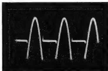
Bild 2c. Durch Symmetrierung der Anordnung ist die Hysterese praktisch verschwunden. Ansteigender und abfallender Teil der Sinuskurve liegen auf gleichem Potential
